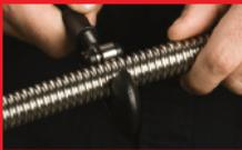
Cortar con el corta-tubos a la longitud deseada
