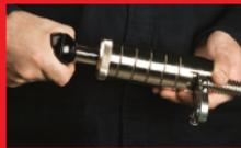
Embutir el extremo del tubo con el pistón
